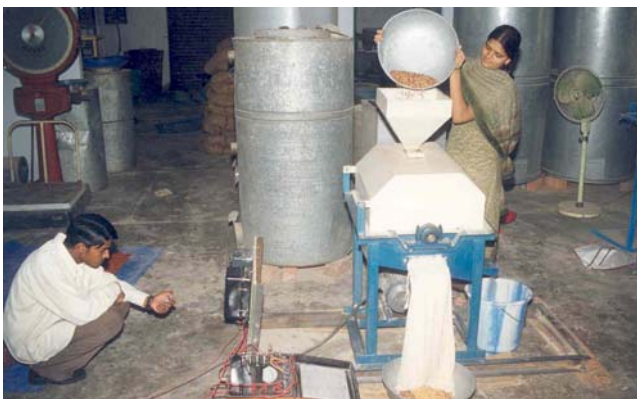
Fig. 1 CIAE dal mill in operation
